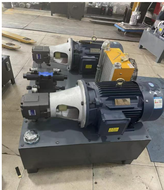
图例：液压站具备双电机
