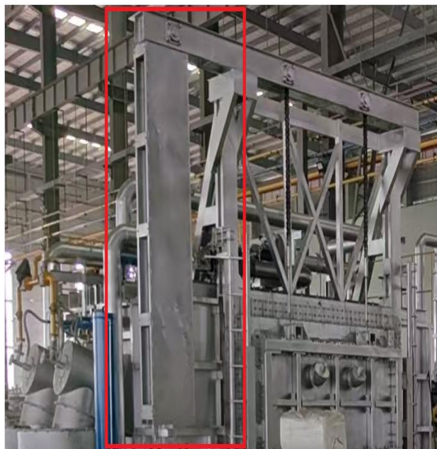
图例：液压缸具备防护罩
